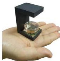
Système de microscopie sans lentille compact, grand champ
